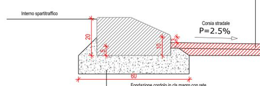
Ricarica su pavimentazione stradale esistente con conglomerato bituminoso sp. variabile
